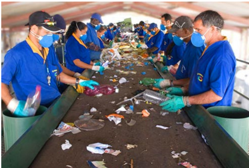
Figura 21 - Esteira de Rolagem para Triagem dos Resíduos.
