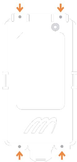
Para remover ou fixar os parafusos utilize chave Philips PH-00
