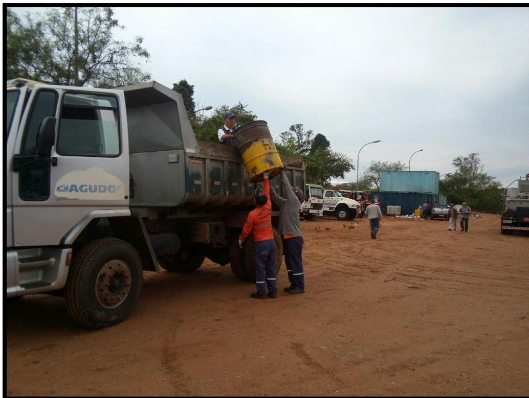
Figura 37 – Um dos caminhões usados para a coleta dos resíduos domiciliares (também é utilizado para coleta de galhos)
